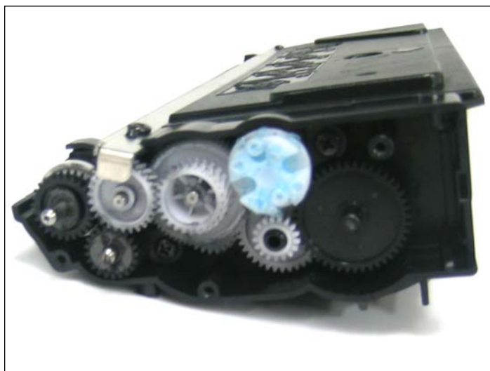
13. Extraiga el resto de los engranajes como se muestra.
