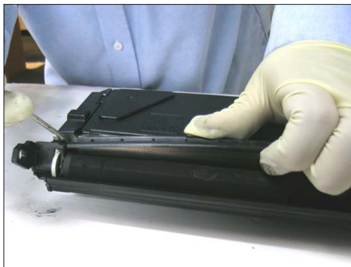
4. Por medio de un desarmador plano, descalce la tapa de la cuchilla de dosificación desde uno de los lados del cartucho como se muestra.
