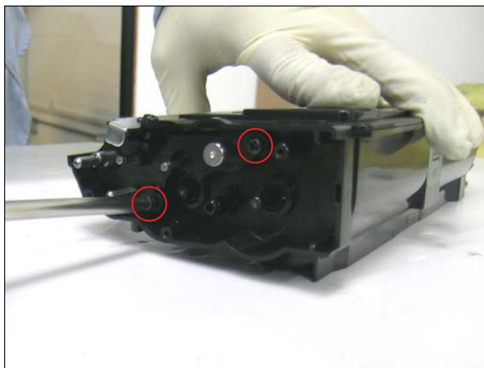
15. Aflojar los tres tornillos que sostienen la tapa lateral de los engranajes.
