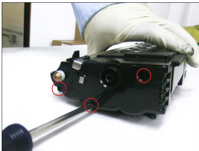
9. Aflojar los tres tornillos que sostienen la tapa lateral, lado sin engranajes.
