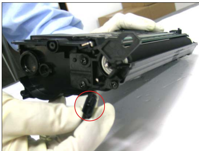
3. Retirar el engranaje de extensión próximo al rodillo de revelación del lado de los engranajes del cartucho.
