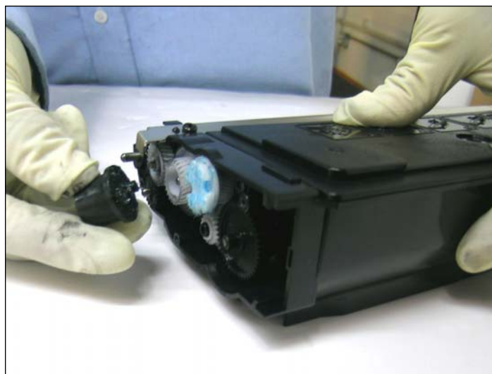
12. Extraer el engranaje externo (negro) como se muestra.
