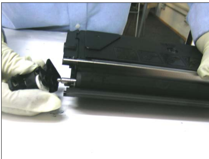
7. Deslice hacia afuera el soporte como se muestra.
