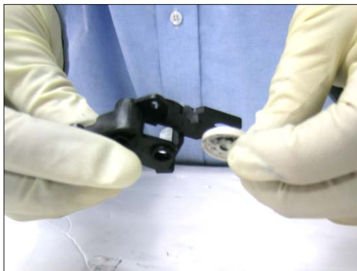
8. Juntar el buje blanco (derecha) con el soporte.
