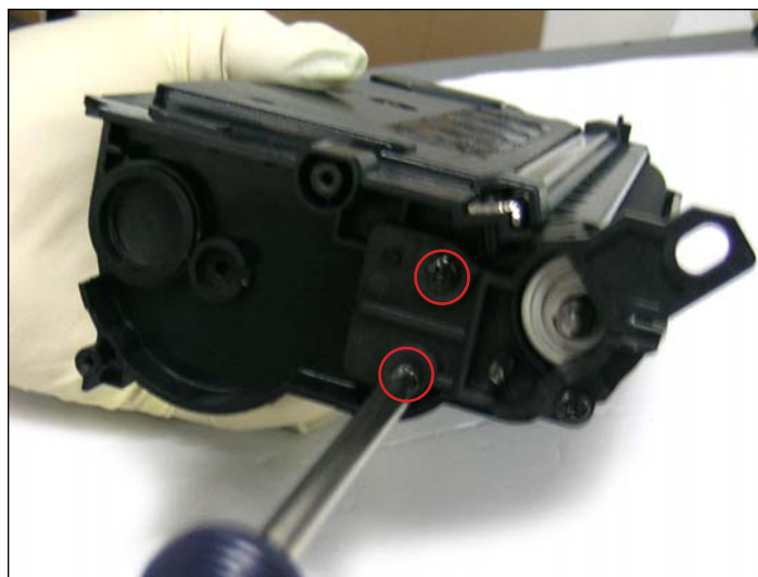
6. Del lado de los engranajes retire los dos tornillos que sujetan el soporte del rodillo de revelación, como muestra la foto.
