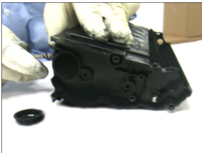
18. Por medio de una pinza de puntas largas retire la tapa de recarga de toner para vaciar y limpiar el deposito.
