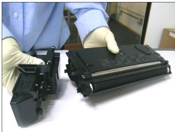
2. Reposito de desperdicios separado.
