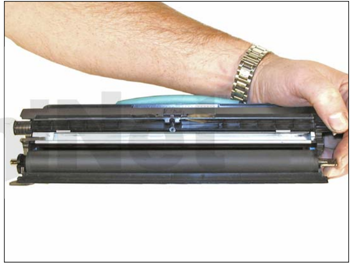
11. Limpie el rodillo revelador con un trapo libre de pelusas, y reinstale el rodillo revelador. En este punto no recomendamos químicos para limpiar este rodillo.
