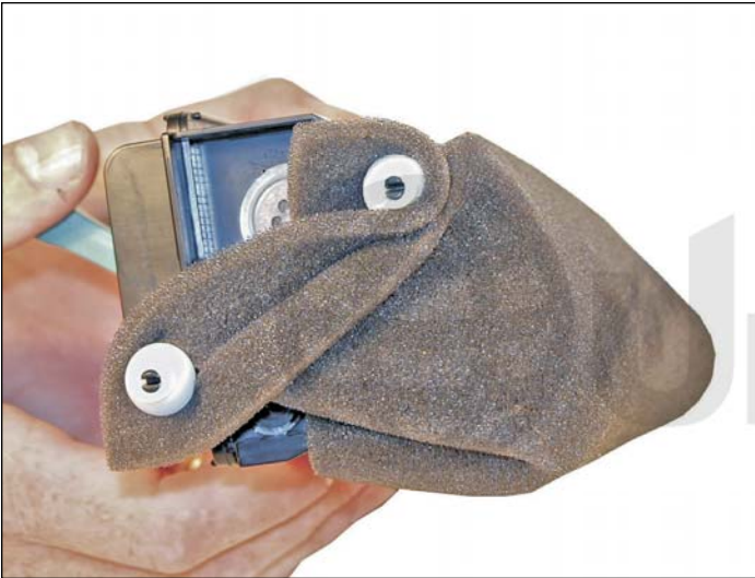
19. Si tiene cubierta de esponja disponible, envuelva el cartucho como se indica. Esta esponja ayuda a proteger el rodillo revelador de sufrir algún daño. Las cubiertas de aftermarket están en desarrollo.
